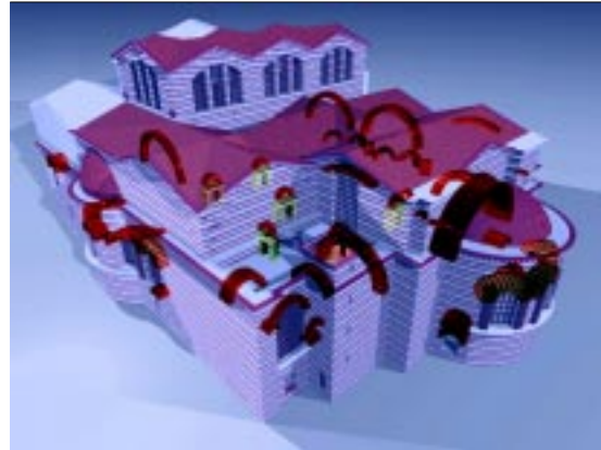
Figure 13. Arch elements of the original plan, modeled in an "include" file. [Les éléments (au premier plan) modélisés dans un fichier "Include," ici celui concernant les arcs.]
