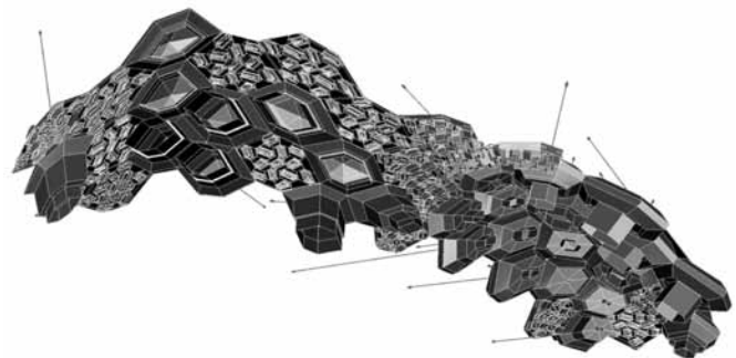
Figura 1. Vista en perspectiva de formaciones de resonadores Helmholtz
