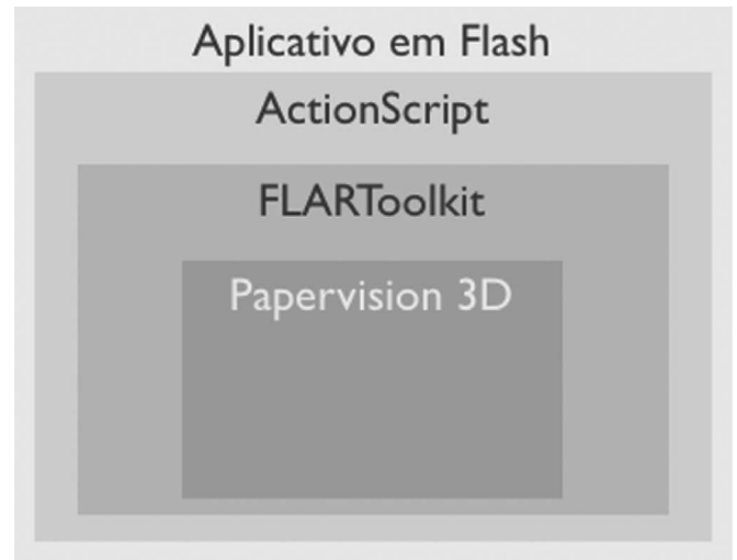
Figura 2: Diagrama das camadas de desenvolvimento do aplicativo.
