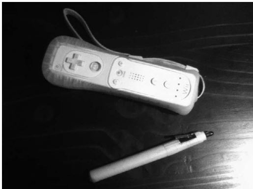
Fig.1 y lápiz infrarrojo, dispositivos necesarios para hacer funcionar la Pizarra interactiva de bajo costo.
